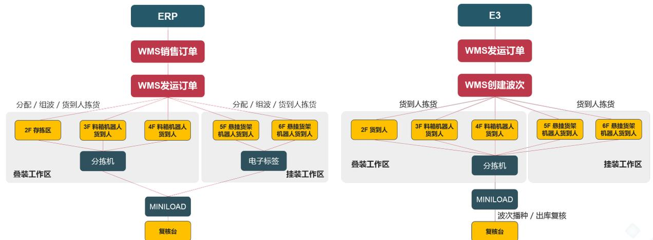
电商订单, WMS接收来自E3系统的订单, WMS根据预设规则,选择同一承运人的订单组建波次,挂装区发送(大)波次拣货任务至海康机器人,叠装区发送(大)波次拣选任务至海柔料箱机器人,批量拣选的单品订单,直接去往复核打包区,其他订单则再通过分拣机进行分拣;完成拣选的唯一品大货订单进入Miniload缓存区集货,待所有商品集齐后复核发运;完成大波次拣选的多品订单,进入立库周转,然后进到复核区进行二次播种,分拣至每个订单。
