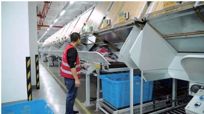
分拣机每个道口对应一个小波次，当翻板通过对应道口，翻板自动翻转将货物投入道口。当滑道内（即一个小波次）所有货品集齐，滑道灯点亮，小波次分拨完毕后，运送至电子标签DAS播种区域，再通过二次播种播至每一订单。
